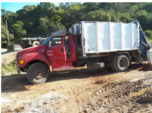
FIGURA 23: CAMINHÃO PRENSA E DESCARTE DE RESÍDUOS ESPECIAIS.
